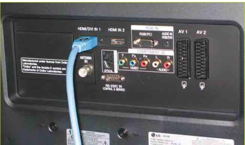
**Abb. 11.7** – Da in immer mehr AV-Geräte eine HDMI-Buchse eingebaut ist, sollten moderne Fernseher mindestens zwei davon besitzen.
