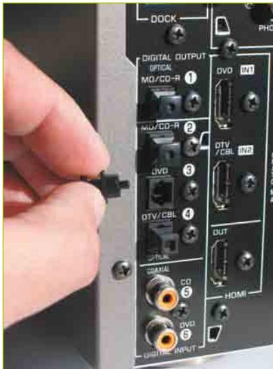
**Abb. 8.3** – Bevor Sie in die optische Audiobuchse ein Kabel stecken können, müssen Sie bei den meisten Geräten zuerst eine Schutzkappe abnehmen.
