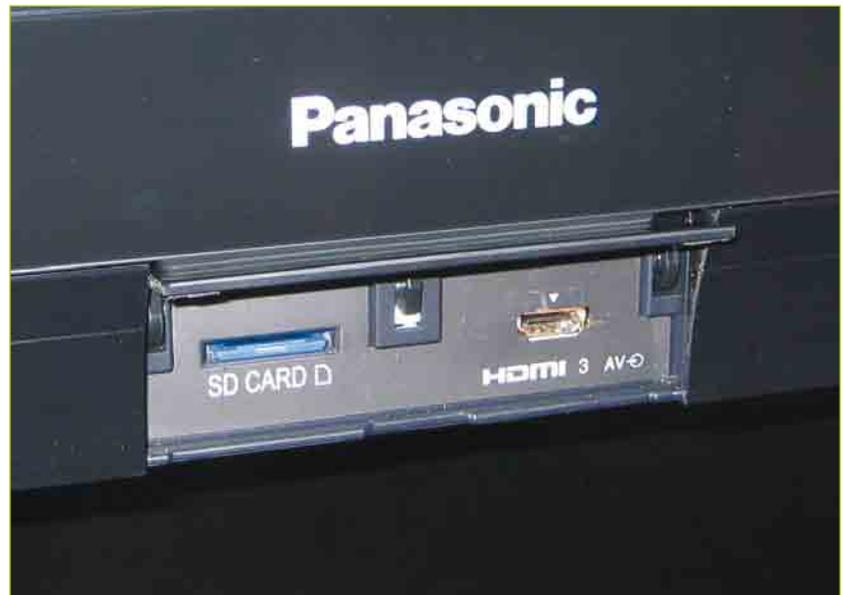
**Abb. 11.10** – Fernseher mit leicht zugänglicher HDMI-Buchse auf der Gerätevorderseite, die sich hinter einer Klappe verbirgt.
