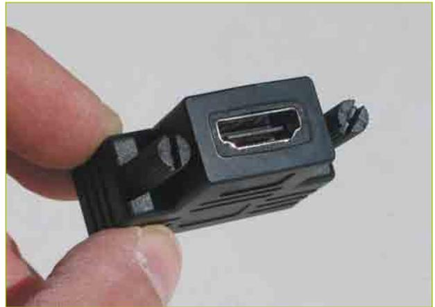
Abb. 11.15 – Rückseite des Adaptersteckers mit eingebauter HDMI-Buchse.
