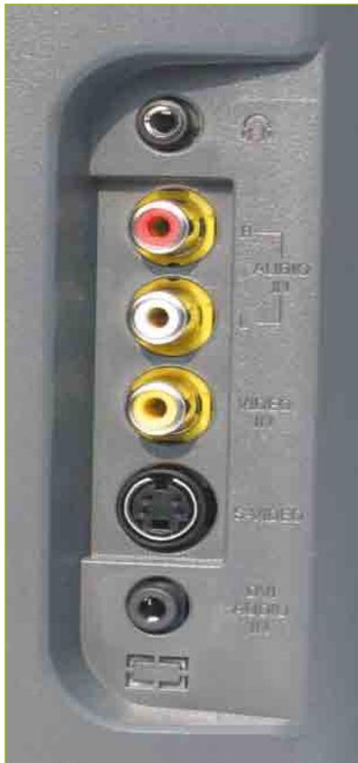
**Abb. 11.16** – DVI-Audio-Eingang an einem Fernseher, der als Klinkenbuchse ausgeführt ist (unterster Steckereingang).
