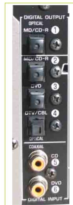
**Abb. 8.1** – Teil der Rückseite eines AV-Receiver mit vier optischen Digitalton-Ausgängen (oben) und zwei koaxialen Digital-Audio-Buchsen (unten).
