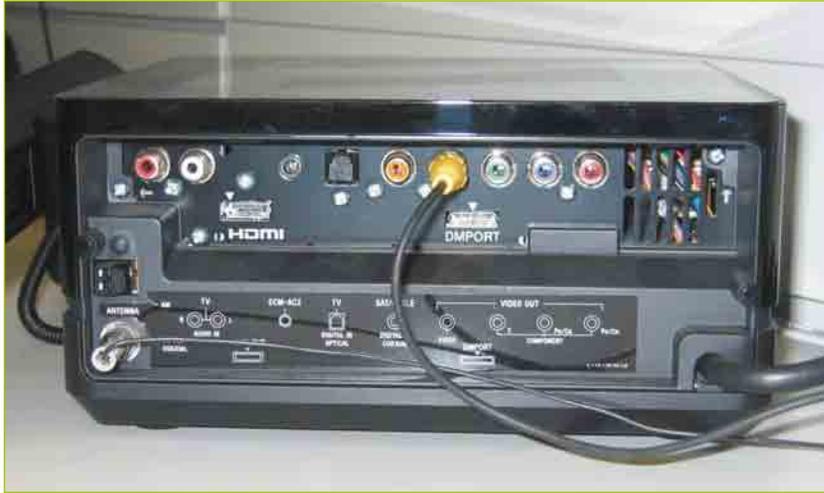
**Abb. 8.14** – Dieses DVD-Komplettsystem besitzt einen analogen und digitalen Audio-Eingang.
