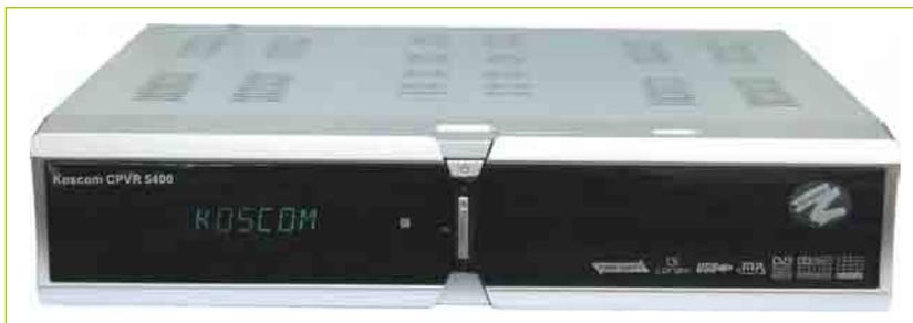
Abb. 1.4 – Digitalreceiver fürs Kabelfernsehen. (Koscom)
