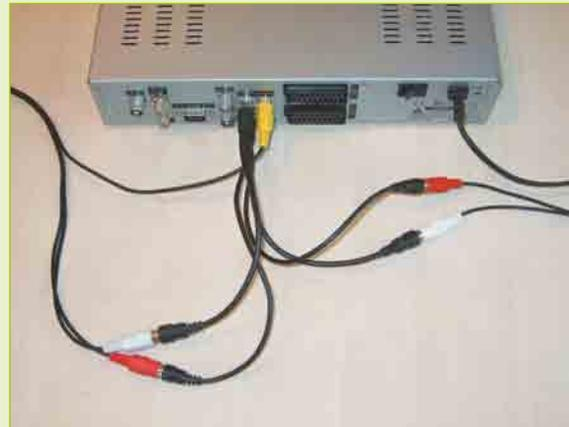
**Abb. 8.12** – Zwei T-Stücke ermöglichen, an die drei Buchsen des Cinch-AV-Ausgangs eine Cinch-AV-Leitung und das Stereokabel für die Hi-Fi-Anlage anzuschließen.
