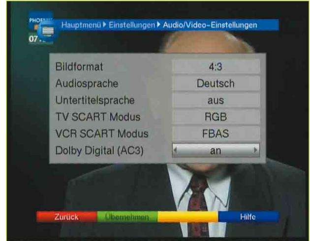
**Abb. 8.7** – Bei einigen Digitalreceivern müssen Sie die Wiedergabe der Dolby-Digital-Tonspur erst aktivieren, um den 3D-Kino-Sound im Wohnzimmer genießen zu können.
