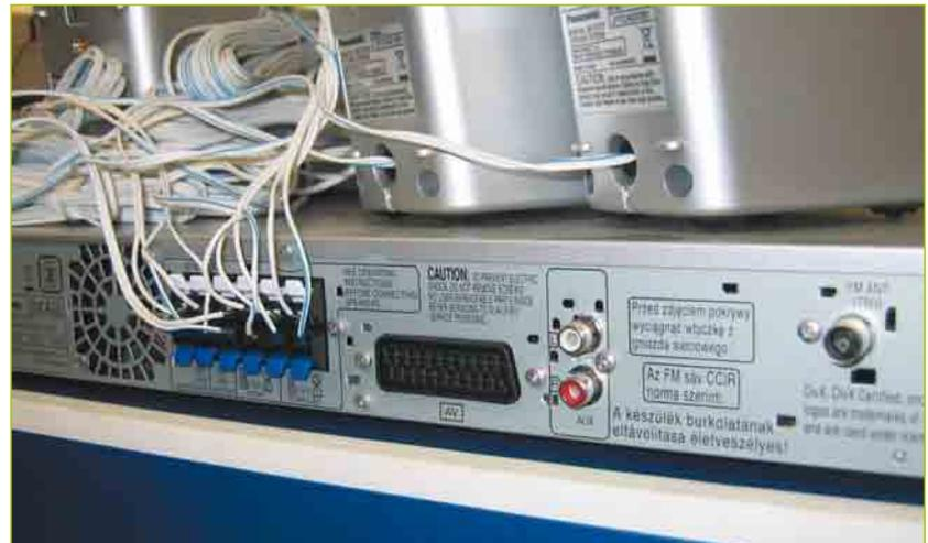
**Abb. 8.15** – Rückseite des Verstärkers einer Stereoanlage: Der AUX-Ausgang, zu erkennen an den beiden Cinch-Buchsen, erlaubt es, Audiosignale des Digitalreceivers in Stereoqualität zu verarbeiten. Für Digitalton und Raumklang ist er dagegen nicht geeignet.
