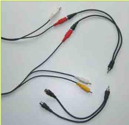
**Abb. 8.11** – T-Stücke sind kleine Adapterkabel, die eine Cinch-Buchse quasi verdoppeln.
