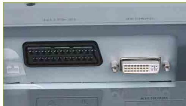
**Abb. 11.12** – Rechts im Bild: eine DVI-Buchse.
