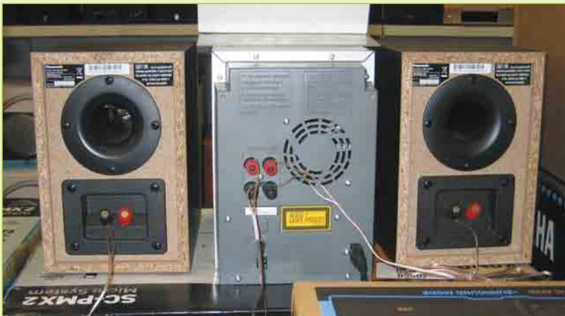
**Abb. 8.13** – Einfache Mini-Stereoanlagen lassen mitunter keinen Anschluss externer Geräte zu. Selbst einen Audio-Eingang sucht man vergebens.
