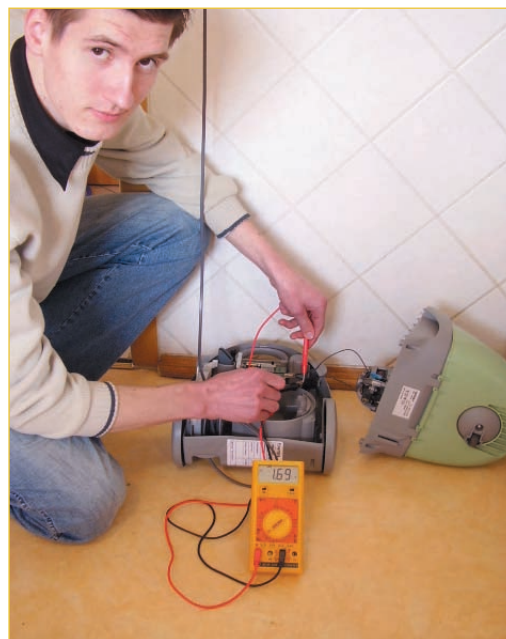
Abb. 6.2 – Ein Anwender misst den Stromverbrauch des Staubsaugers. Eine zweite Person steckt dafür kurzzeitig den Netzstecker in die Steckdose. Die einschlägigen Sicherheitsvorschriften sind zu beachten.
