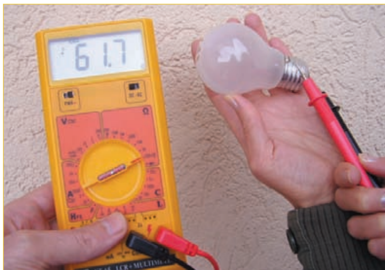
Abb. 6.5 – So lässt sich prüfen, ob der Leuchtfaden der Glühlampe durchgebrannt ist. Der Kaltwiderstand dieser 60-W-Glühlampe beträgt 61,7 \Omega . Das sind 7 Prozent vom Heißwiderstand (882 \Omega ).
