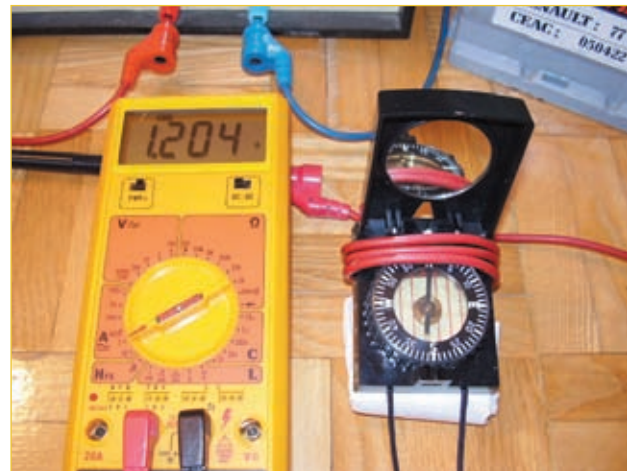
Abb. 1.4 – Strom von 1 \text{ A} kann eine Kompassnadel durch sein Magnetfeld ablenken, wenn man das stromdurchflossene Kabel mehrmals um den Kompass wickelt.
