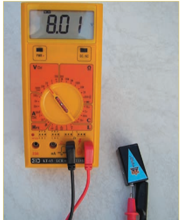
Abb. 10.3 – An einer älteren 9-V-Batterie liegt die Leerlaufspannung ohne angeschlossenen Stromverbraucher bei 8 V.
