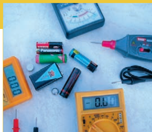
Abb. 10.1 – Mit jedem Multimeter lässt sich die Spannung an Batterien und Akkus messen.
