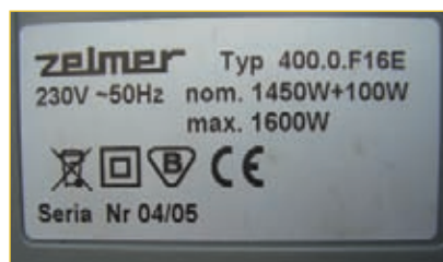
Abb. 6.1 – Das Typenschild eines modernen Staubsaugers informiert über die Nennleistung, mit der man den Nennstrom errechnen kann.
